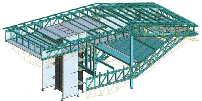
Principe constructif du volume métallique connecté au massif béton.
