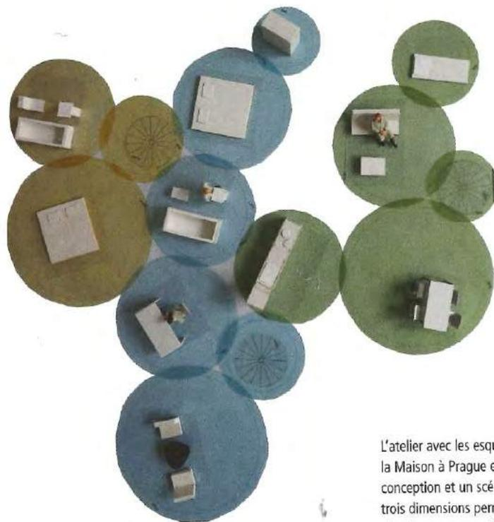
L'atelier avec les esquisses de la Maison à Prague en cours de conception et un scénario en trois dimensions permettant de simuler une occupation possible de ses espaces. Des cylindres de trois tailles différentes qui communiquent entre eux par de multiples tangences afin de permettre des effets d'enfilades et de mises en abyme.
