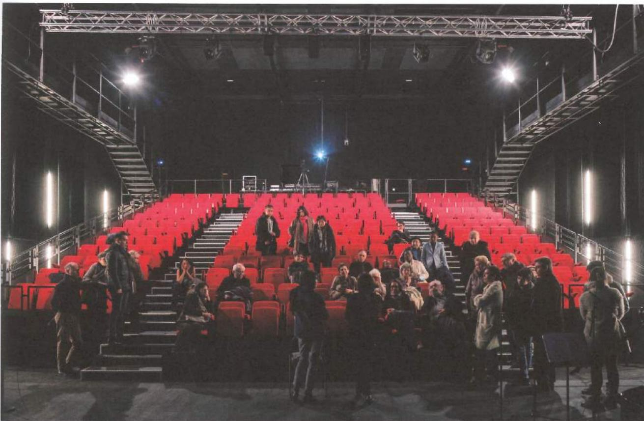
La salle Claude-Charasse est entièrement modulable avec des gradins télescopiques permettant différentes configurations
