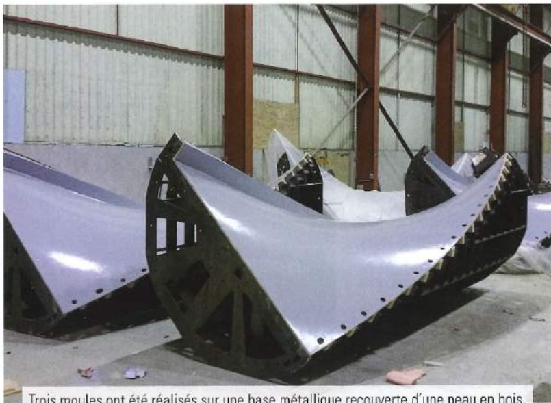
Trois moules ont été réalisés sur une base métallique recouverte d'une peau en bois.
